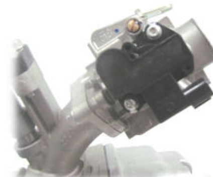
เซนเซอร์ตรวจวัดตำแหน่งลิ้นเร่ง (รหัสโค้ด 14 )
