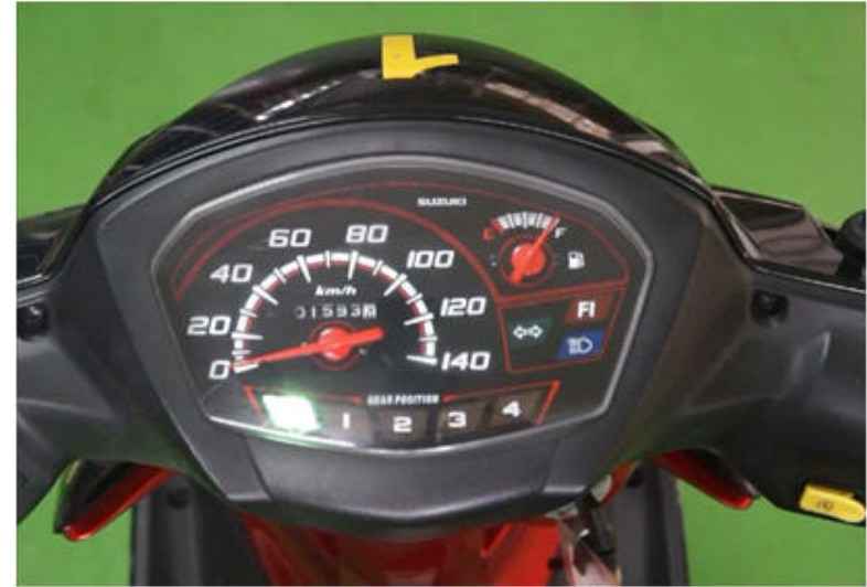
B : ไฟเตือน FI ติดสว่างและกระพริบ
